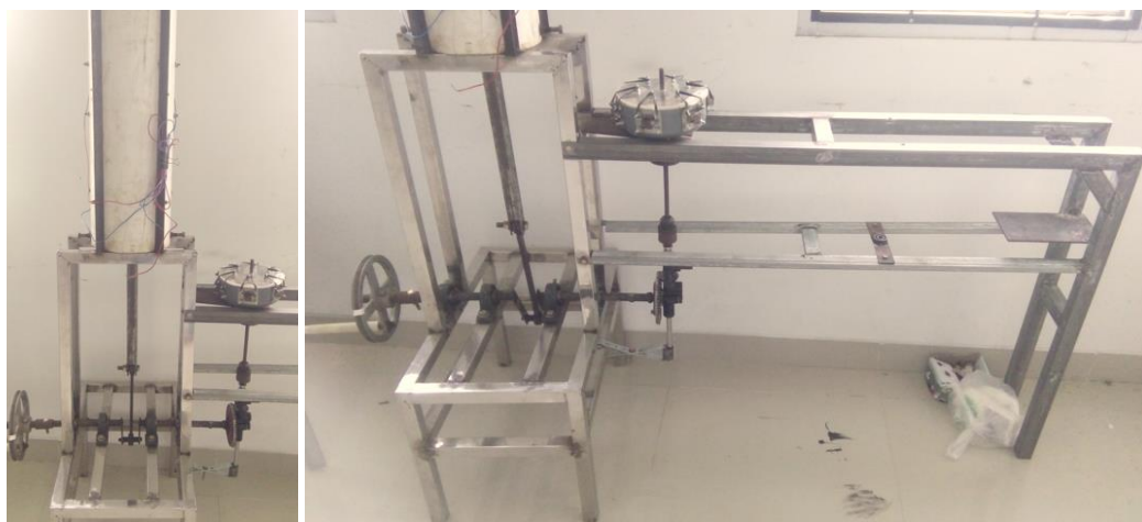
Gambar 4. Hasil pembuatan generator AC gerak translasi dan rotasi
