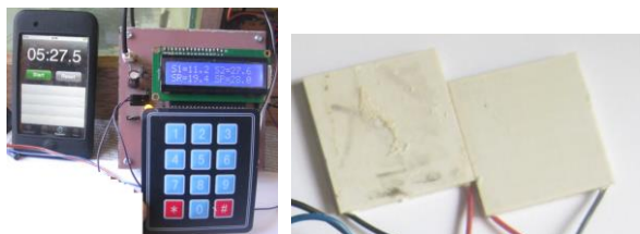
c. LCD, Key Pad dan Komponen Pemanas dan Pendingin Temperatur Air Laut (Peltier)
