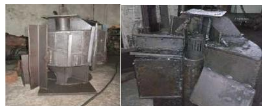
G.19 Dudukan untuk penarikan blade di mesin jack
