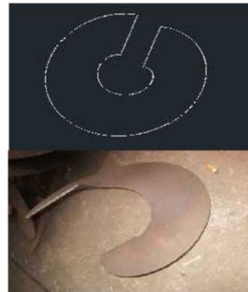
G.11 Lempeng blade ditarik mesin jack untuk menentukan lebar pitch
