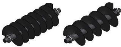
G.17 Model 3D turbin screw 7 lempeng dan 5 lempeng
