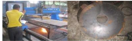
G.18 Pemotongan pelat dengan Oxy dan hasil bentuk lingkaran
