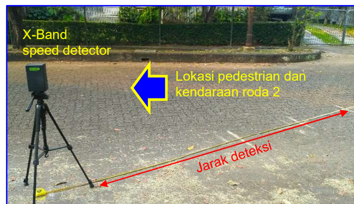
Gambar 8. Posisi Sensor HB100 diletakkan pada Sudut yang telah ditentukan Menghadap ke Kendaraan yang Melintas
