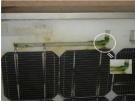
Gambar 2.3 Korosi pada Panel Surya [24]
