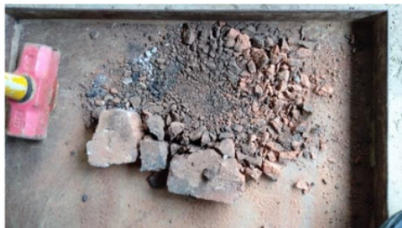
Gambar 3. Proses Pembuatan Serbuk Bata Merah
