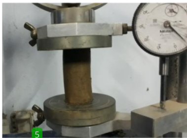
Gambar 1 Pengujian kuat tekan bebas tanah dengan campuran semen portland komposit
