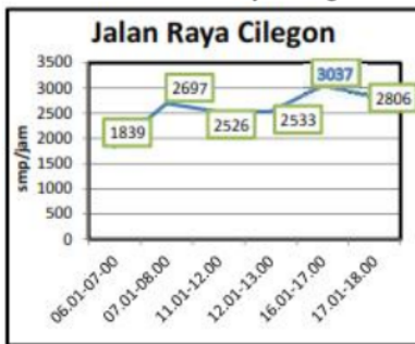
Gambar 6. Volume maksimum kendaraan jalan Raya Cilegon pada hari libur (Sumber : Hasil Analisis 2015)
