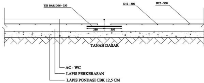
Gambar 3. Potongan Melintang (A-A) Perkerasan Kaku (Sumber: Hasil Analisis, 2015)
