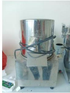
**Gambar 3.2** Mesin pencacah jerami
