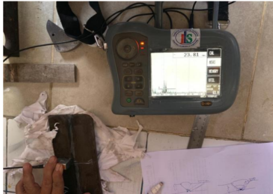
Gambar 3.3 Sampel Cacat Porosity Dengan Ultrasonic Test
