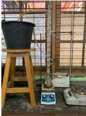
Gambar 3.4 Rangkaian Alat Pengujian Korosi Metode Weight Loss Ferric Sulfate-Sulfuric Acid .
