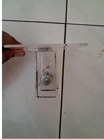
Tahap 7 Penggabungan alas permukaan benda uji
