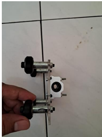
Tahap 5 Pemasangan roda bearing
