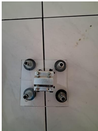
Tahap 6 Pemasangan rumah untuk sliding pada poros ulir
