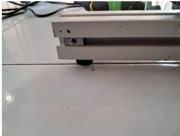
Tahap 2 Pemasangan Sliding Nut pada batang Aluminium
