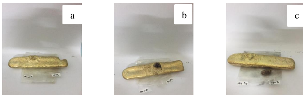
Gambar 4.12 (a) Sampel Mn 0,6% 350°C, (b) Sampel Mn 0,8% 350°C, dan (c) Sampel Mn 1,0% 350°C
