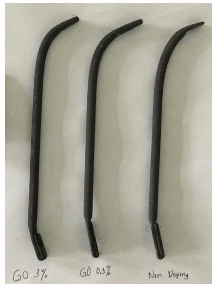
Gambar 3.9 Sampel Wire sebelum rolling
