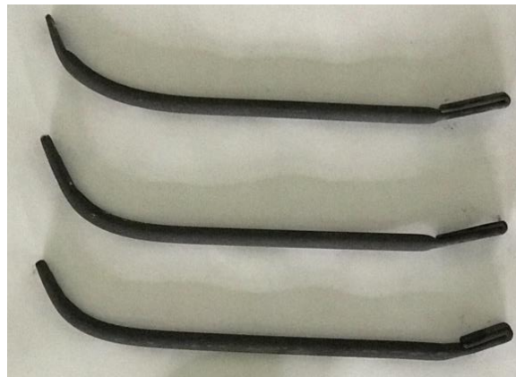
Gambar 3.8 Sampel Wire setelah sintering
