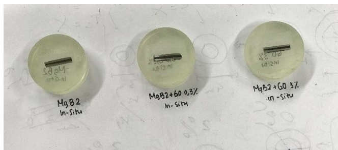
Gambar 3.14 Hasil dari Mounting dan Grinding
