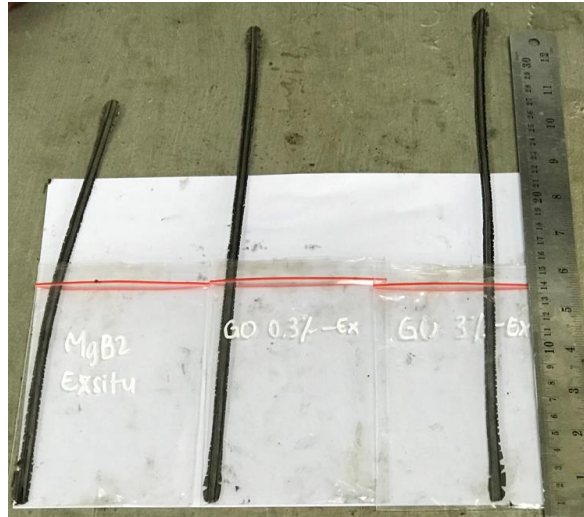
Gambar 3.10 Sampel wire setelah proses rolling
