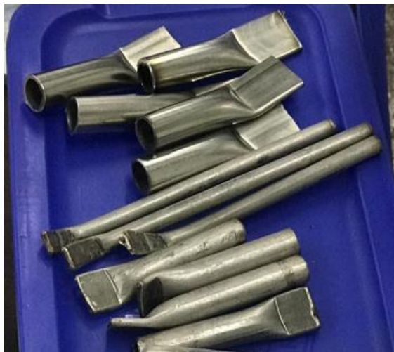
Gambar 3.4 Tabung yang akan di isi oleh bahan dan kemudian di sintering
