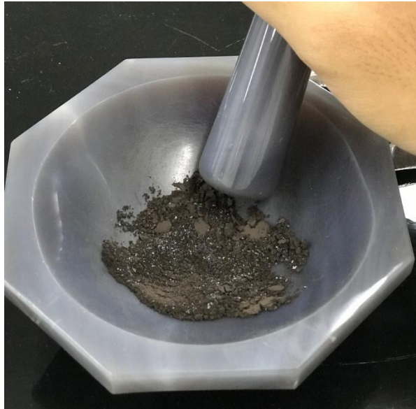
Gambar 3.3 Proses Pencampuran Menggunakan Morgar Gaate
