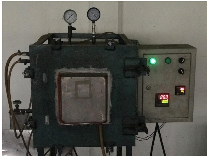
Gambar 3.6 Proses sintering dengan suhu 800^{\circ}\text{C} dan waktu tunggu 2 jam
