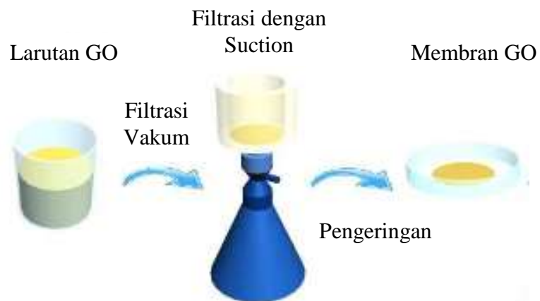
Gambar 2.3 Skema Proses Pembuatan Membran GO dengan Filtrasi Vakum(Wang, 2015)
