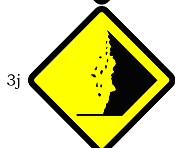
Peringatan Bagian Tepi Jalan Sebelah Kanan yang Rawan Runtuh
