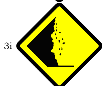
Peringatan Bagian Tepi Jalan Sebelah Kiri yang Rawan Runtuh
