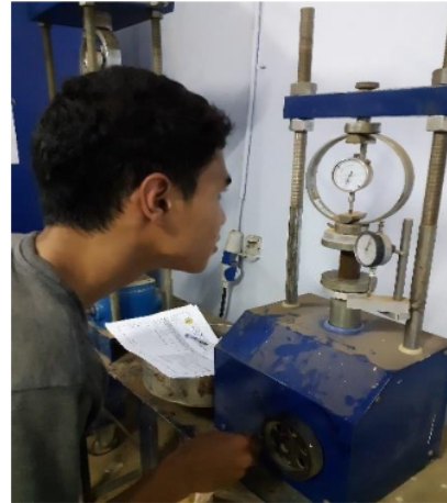
Gambar 7. Pengujian Kuat Tekan Bebas Sumber: Dokumentasi Penulis, 2019
