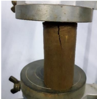
Gambar 13. Pola Keruntuhan Tanah Asli Sumber: Dokumentasi Penulis, 2019
