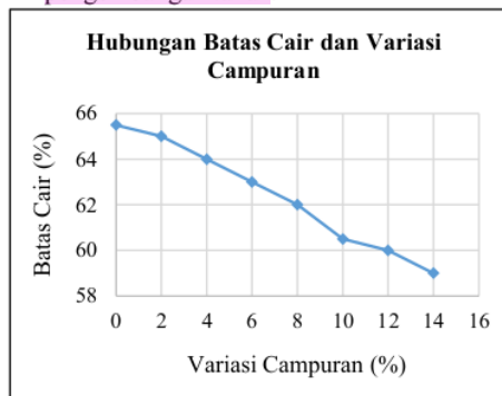
Gambar 4. Grafik Pengujian Batas Cair Sumber: Analisis Penulis, 2021
