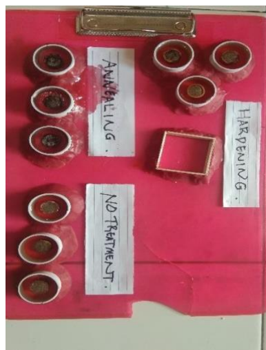
Gambar 3.3 Sampel Yang Di Mounting
