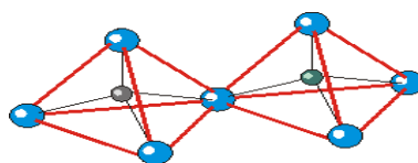
Gambar 2.1 Tetrahedra Alumina dan Silika ( \text{TO}_4 ) pada Struktur Zeolit
