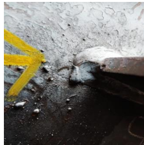
Gambar 4.3 Cacat Spatter (Sumber: Dokumen Pribadi)
