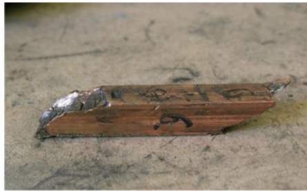
Gambar 3. Contoh sampel retak akibat distribusi tegangan yang tidak merata (Kollo et al. 2012)
