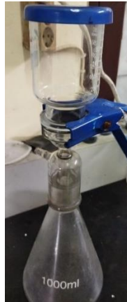
Gambar 3.4 Skema Vakum Filtrasi
