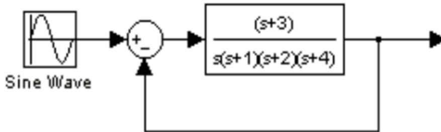
Gambar 9.1 Diagram Blok Sistem \frac{(s+3)}{s(s+1)(s+2)(s+4)} dengan penguat K=1 .
