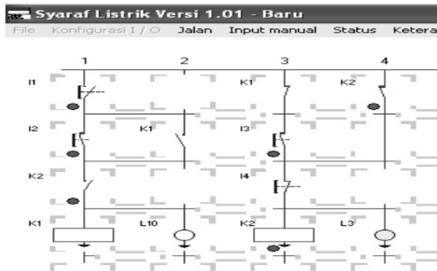
Gambar 16.12 Rangkaian Star/Delta Motor Listrik, 2 Kontaktor Menggunakan Syaraf Listrik [9]
