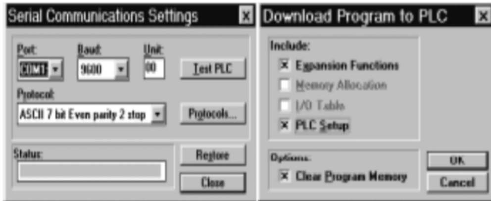
Gambar 10.10 Proses Seting Pada Saat Down Loading Program Dari PC Ke PLC
