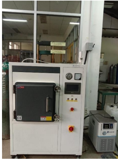
Gambar 3.8 Proses Rapid Thermal Annealing pada Muffle Furnace
