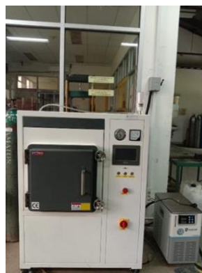
Gambar 3.3 Proses Preheating pada Muffle Furnace
