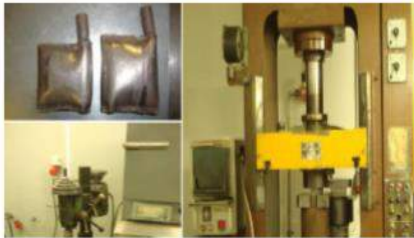
Gambar 2.5 Modifikasi SHS Menggunakan Furnace dan Mesin Press (Pramono, 2016).
