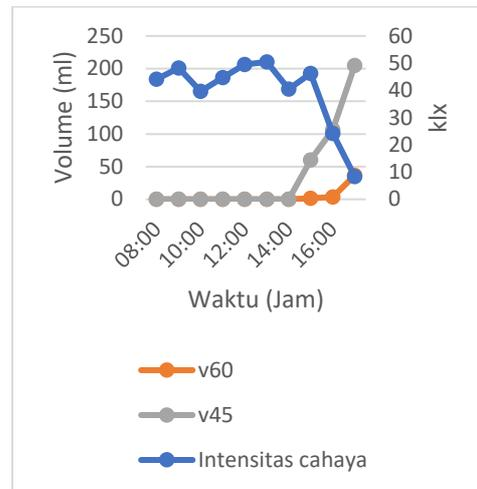
Gambar 9. Produksi kondensat pada siang hari jam 08.00 – 17.00
