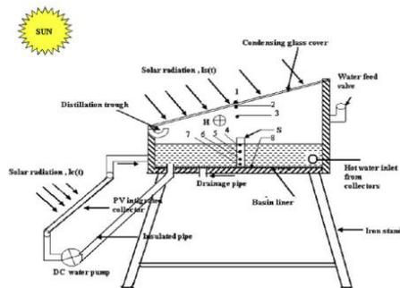
Gambar 5. Distilasi surya dengan PV Thermal (Manokar dkk, 2018)
