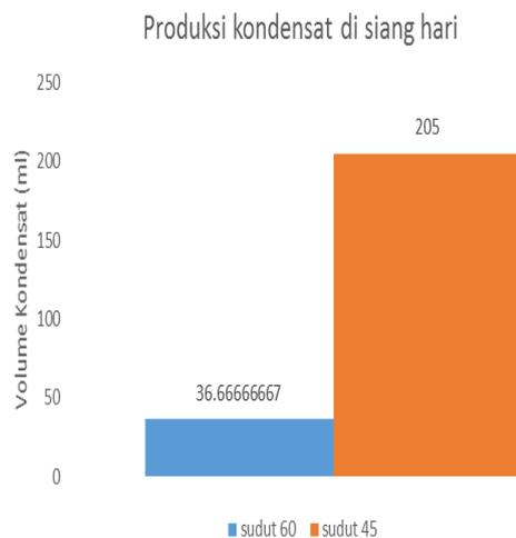
Gambar 10. Produksi kondensat rata-rata pada siang hari (jam 08.00 – 17.00)
